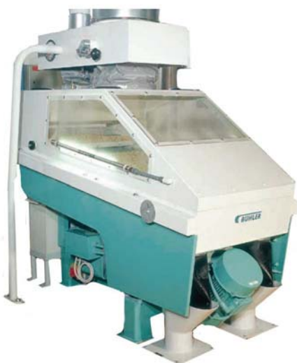
Abajo: Equipo de pre limpieza para el grano de Quinua
